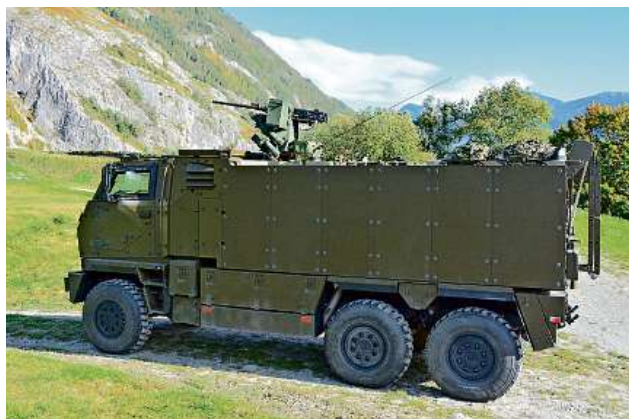
Geschütztes Mannschaftstransportfahrzeug (GMTF) mit aufgebautem Maschinengewehr mit 12,7-mm-Munition.
