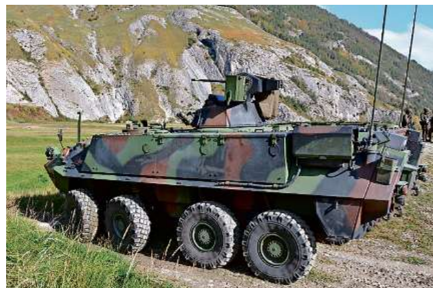
Radschützenpanzer 93 (Mowag-Piranha 8x8) mit aufgebautem Maschinengewehr mit 12,7-mm-Munition.
